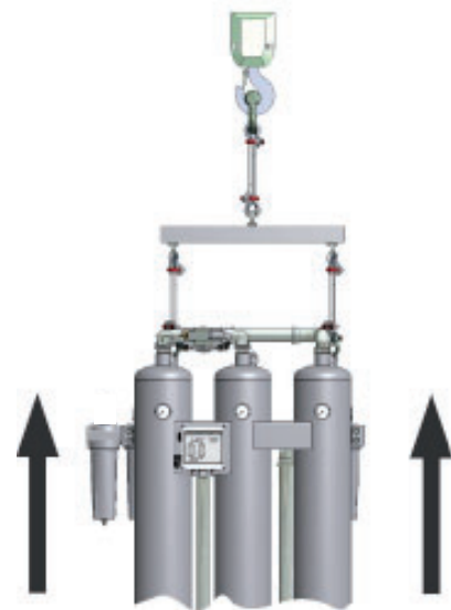
II: Aufstellen mit Kran
